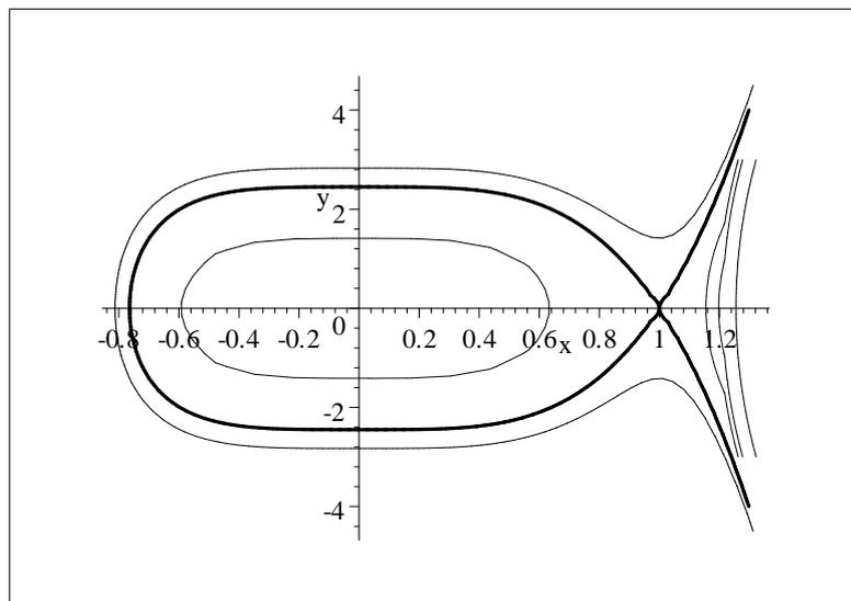
Le orbite a energia 3, **indicate in grassetto**, si incrociano nel punto  $x = 1$  con tangenti diverse da 0, perchè l'equazione dell'orbita a energia  $E = 3$  è  $3 = y^2/2 + 7x^4 - 4x^7$ , che, in vicinanza di  $x = 1$ , ponendo  $x = 1 \pm \epsilon$ , diventa:
