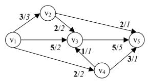
dove i dati sono nella forma  $capacità/flusso\ corrente$ . Determinare il flusso massimo da  $v_1$  a  $v_5$  con l'algoritmo di Ford e Fulkerson, analizzando nodi e archi per indici crescenti.
