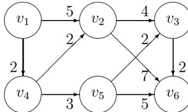
Determinare i cammini minimi da  $v_1$  a tutti gli altri nodi utilizzando l'algoritmo di Dijkstra.
