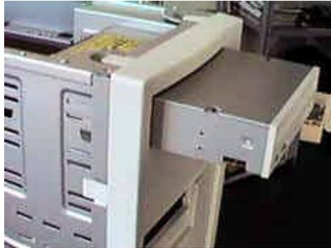
Una volta installati questi componenti, serrando molto bene le viti utilizzandone almeno quattro per ogni componente, possiamo passare alla seconda fase, il montaggio della motherboard nel case.
