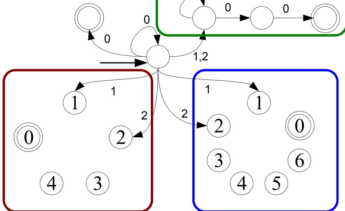
Questa parte dell'atoma riconosce i numeri multipli di 5. L'arco con etichetta  $i$  che esce dallo stato  $j$  porta allo stato  $3j+i \pmod{5}$  (questi archi non sono stati disegnati).
